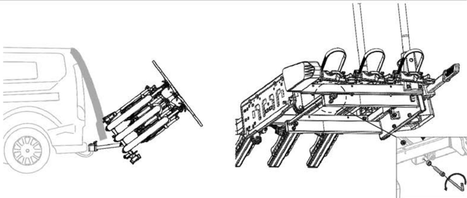
(SK) Odstránením zarážky otáčania môžete produkt viac nakloniť, sprevádzať bicykle, aby ste predišli poškodeniu.
