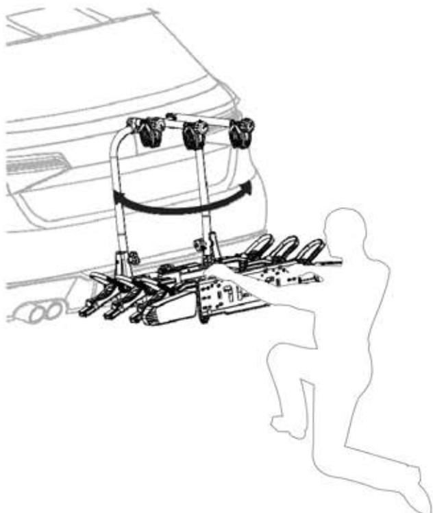
(SK) Skontrolujte, či sa nosič bicyklov neotáča, ak je výrobok upevnený, pokračujte krokom 10 v opačnom prípade prejdite na krok 09 a nastavte uzamykací systém.
