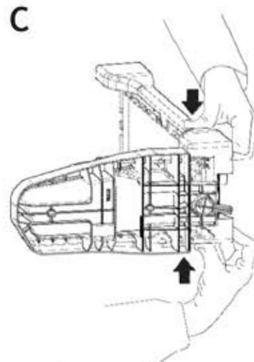
(SK) Vložte kolík 1A do otvoru 1B držiaka ŠPZ, otočte držiak svetla tak, aby sa kolík 2A zasunul do otvoru 2B (obrázok B), v prípade potreby mierne potiahnite držiak ŠPZ, keď je v polohe, zatlačte na ŠPZ držiak, ako je znázornené na obrázku C, aby kolíky zapadli.
