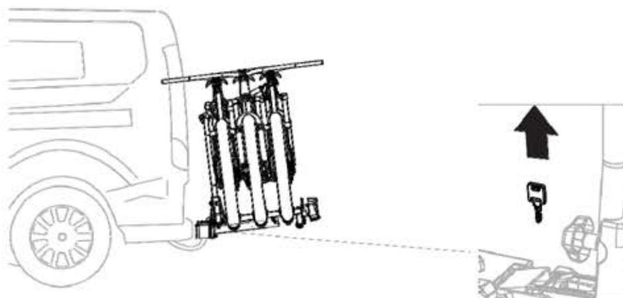
(SK) V prípade vozidla s dlhými dverami batožinového priestoru vždy pred ich otvorením vyberte kľúč.
