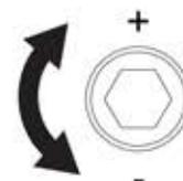
(SK) Na zvýšenie sily zatvárania ručne otočte skrutku o 1/4 otáčky, potom spustíte páku a skontrolujte tesnosť výrobku, v prípade potreby opakujte operáciu, kým nenájdete správne upevnenie.
